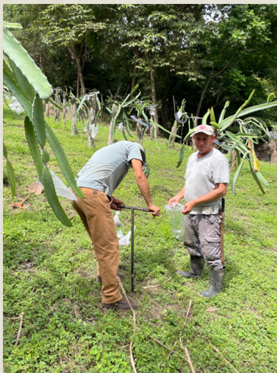
Tomando muestra para estimar carbono orgánico en el suelo con barreno a 0-30 cm de profundidad.
