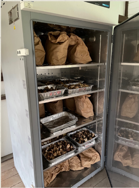
Proceso de secado de muestras en horno con sistema de aire caliente.
