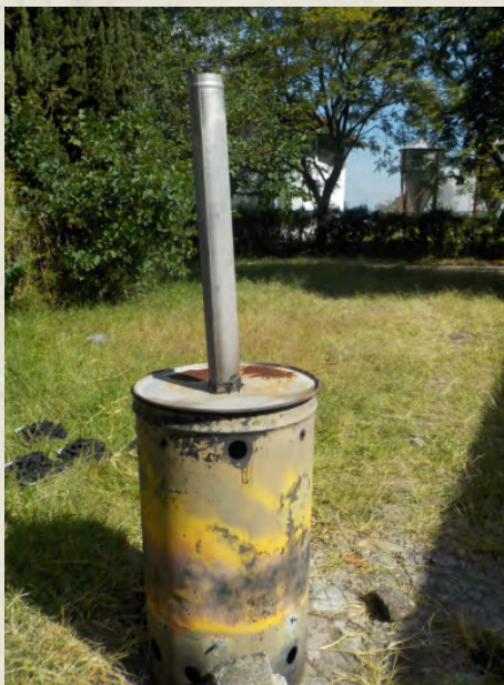
Figura 2. Reactor de pirólisis lenta para producción de biocarbón. Fotografía: Lenin Medina.
