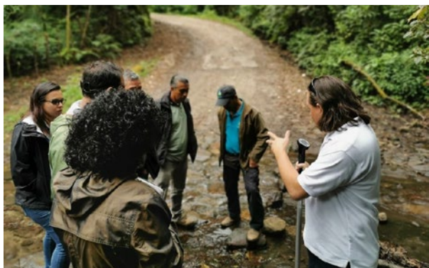
Figura 2. Uso de equipo (caudalímetro) para medir la velocidad del caudal. Fotografía: María Álvarez.
