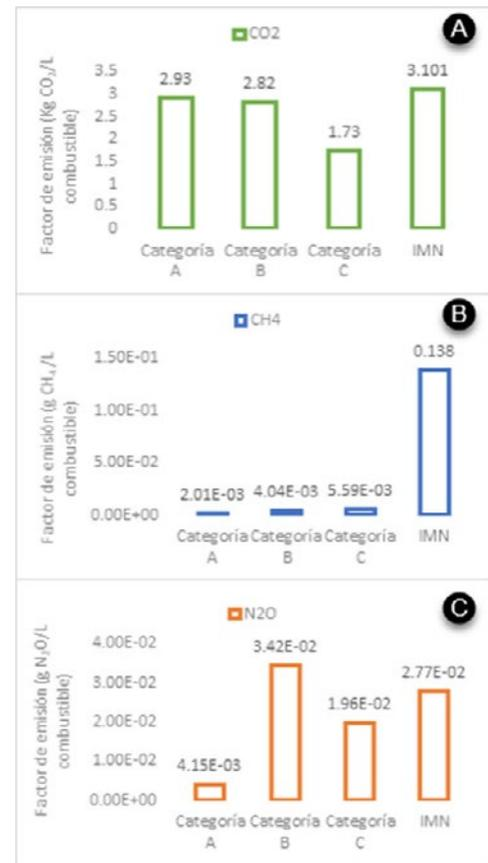
**Figura 4.** A) Factores de emisión de dióxido de carbono, B) Factores de emisión de metano y C) Factores de emisión del óxido nitroso; obtenidos todos por el LAA-UNA de datos promedio para una caldera tipo A, B y C respectivamente, que utilizan como combustible el búnker en comparación al factor de emisión establecido por el IMN.
