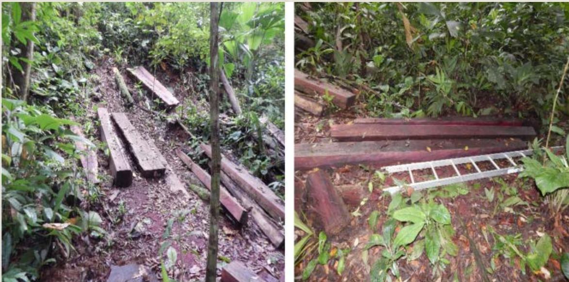
Figura 3. El aserrío in situ permite recuperar la madera en cuadro, con lo cual se aumenta su rendimiento de transporte.
